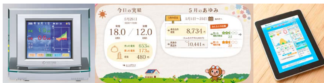
写真 4-3-3 発電電力、消費電力の「見える化」＜例＞
