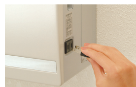
非常用コンセント (屋内設置パワーコンディショナの例)
