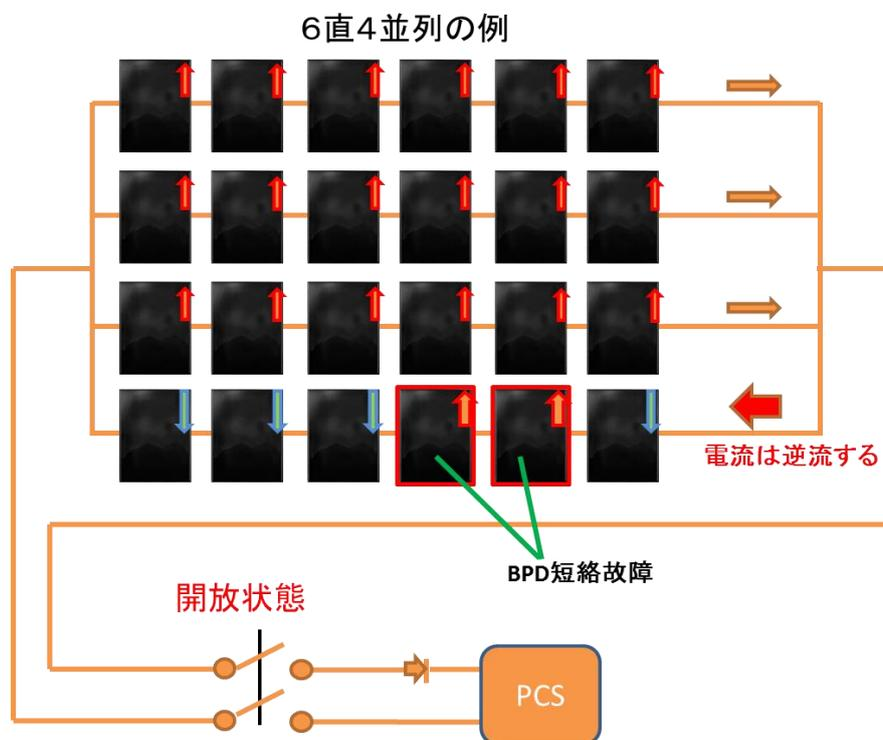
**解説図 13 CIS 太陽電池のバイパス回路ショート故障の事例**
