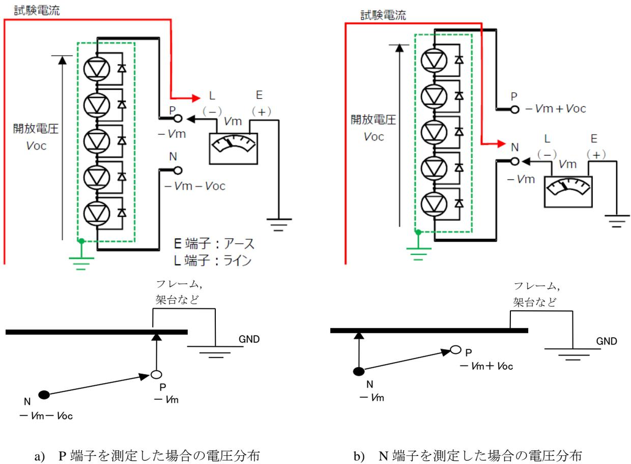
解説図 5 - 絶縁抵抗測定回路
