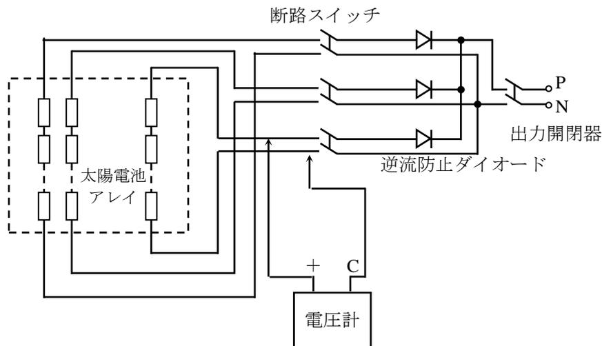
**解説図 7 – 開放電圧測定回路例**
