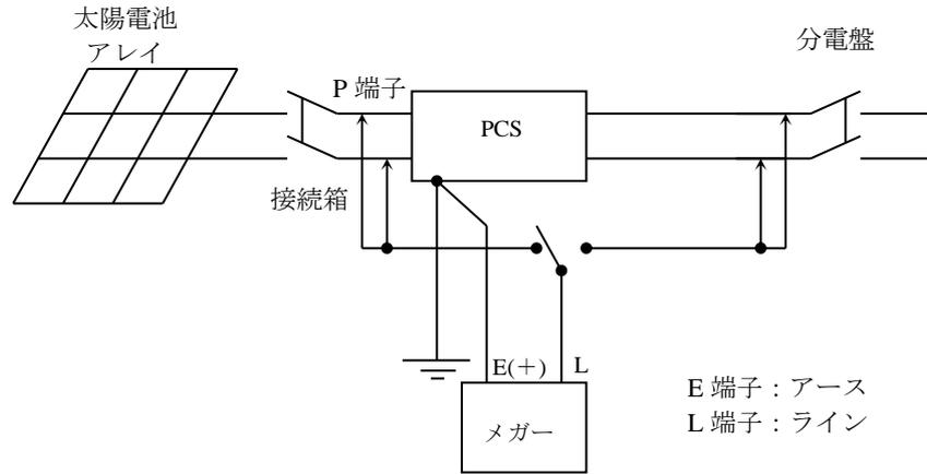
解説図 4 - 絶縁抵抗測定回路
