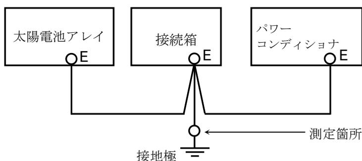
解説図 8 – 接地抵抗測定箇所
