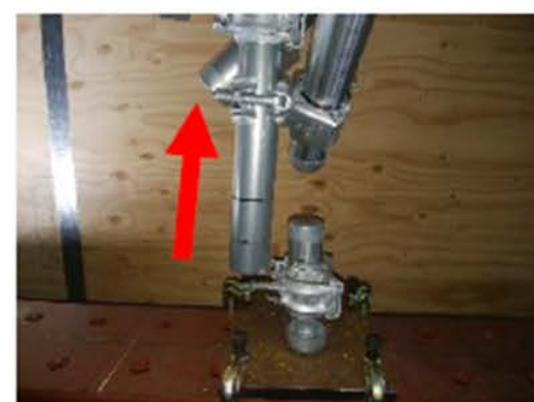
緊結金具（単管クランプ） による接合
