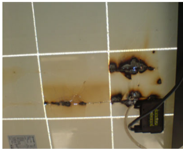
太陽電池モジュールからの異常発熱・発火事例
