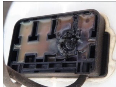
太陽電池モジュールからの異常発熱・発火事例
