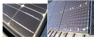
設置 7 年後全数剥離 設置 17 年後全数拡大
