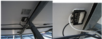
設置後 8 年で落下 端子箱内の充電部露出 バイパスダイオードがポットングされていない端子箱。
