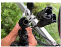
コネクタ変形/溶着 /焼損
