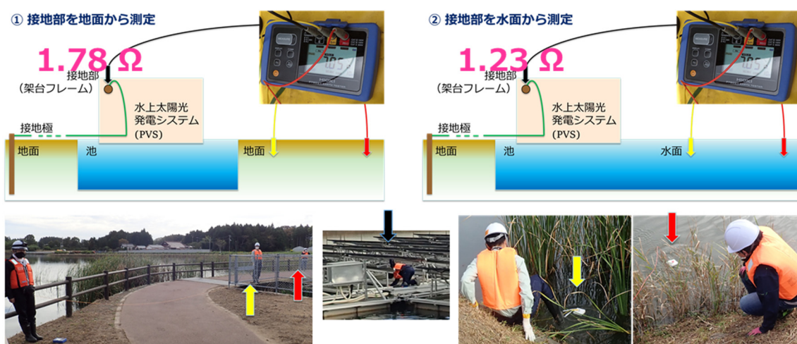
図 14-3 水上設置型太陽光発電設備の接地抵抗測定の概要
