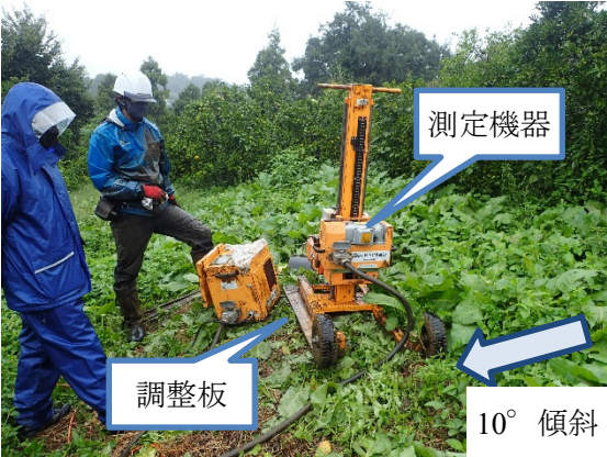
図 2-1 農地（傾斜）の地盤調査風景
