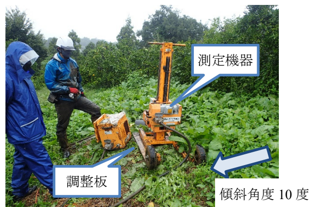
図 2-9 傾斜地の地盤調査風景
