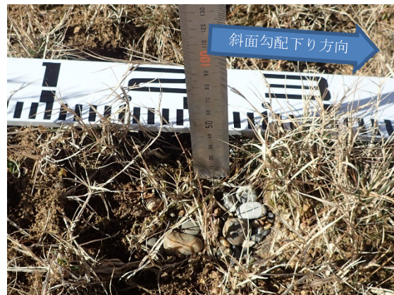
図 5-4 15 度植生工 雨だれ集中位置（左：落下位置拡大、右：侵食深さ）
