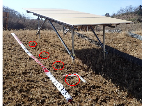
図 5-2 15 度植生工 架台（長辺傾き 3 度）
