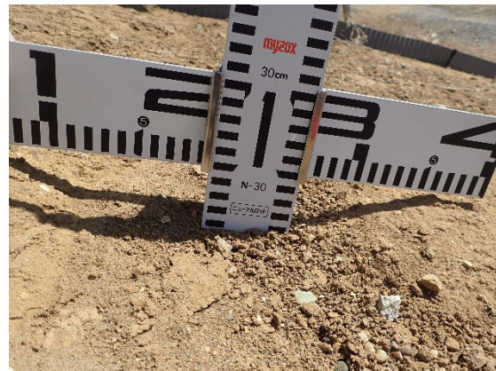
図 5-7 30 度裸地 雨だれ位置の最大侵食深さ（左：中間、右：水下側）
