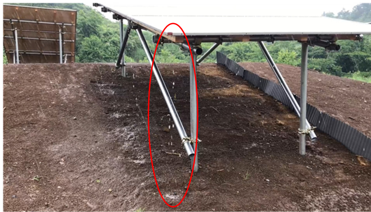
図 4-5 降雨時模擬 PV (傾斜 15 度_裸地)
