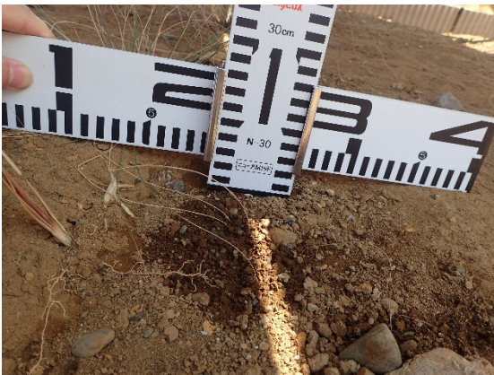
図 5-7 30 度裸地 雨だれ位置の最大侵食深さ（左：中間、右：水下側）
