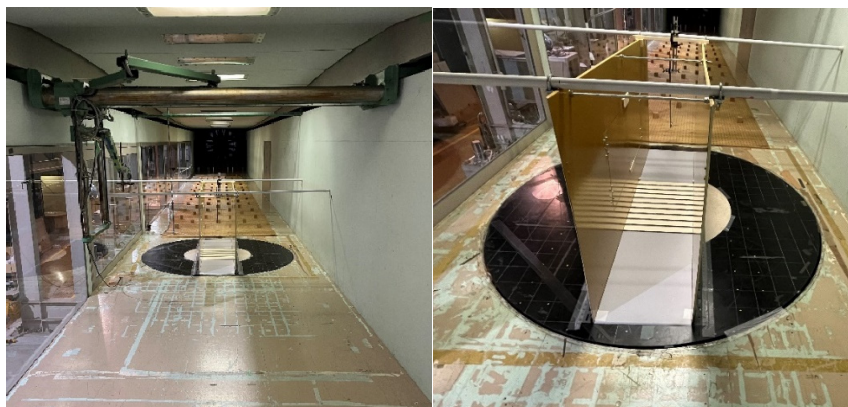
写真 2-1 風洞内模型設置状況
