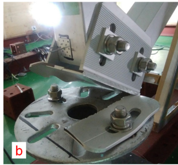
基礎締結金具の破損 (2600 Pa)
