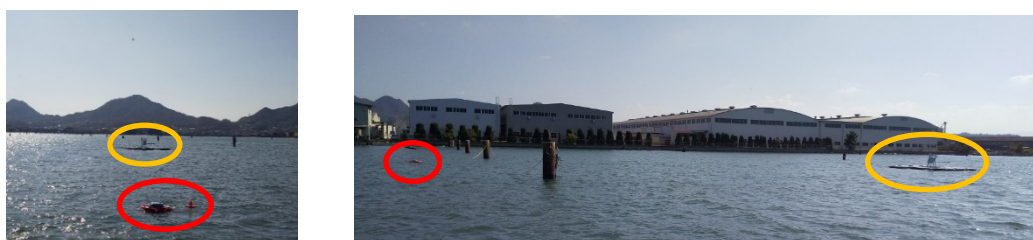
図 3-23 詫間港への波浪観測ブイ及び風速計設置状況 (赤丸は波浪観測ブイ、黄丸は風向風速計設置位置を示す)
