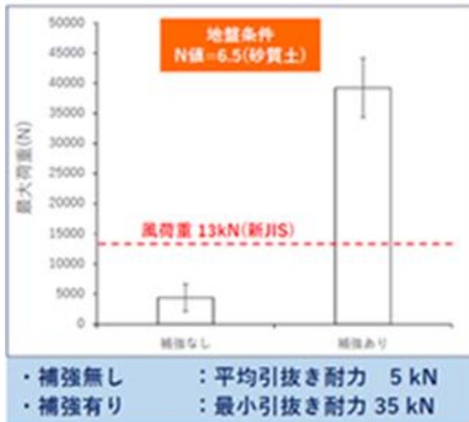
模擬架台を用いた補強能力の確認
