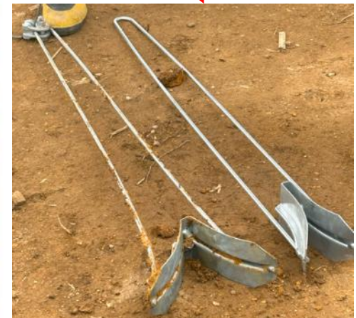
補強アンカーの施工前後の形状比較
