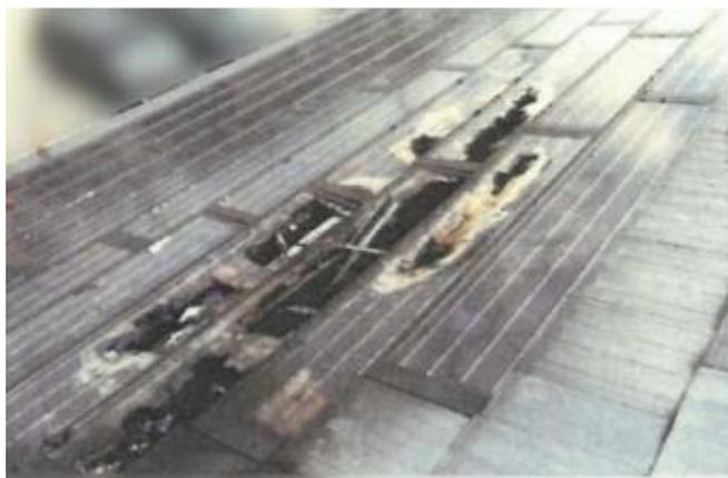
写真 2-5 住宅に設置された太陽光発電設備の火災事例
