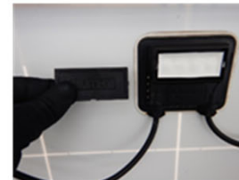
絶縁抵抗低下 B 電気測定 地絡 部分的な高抵抗 化
