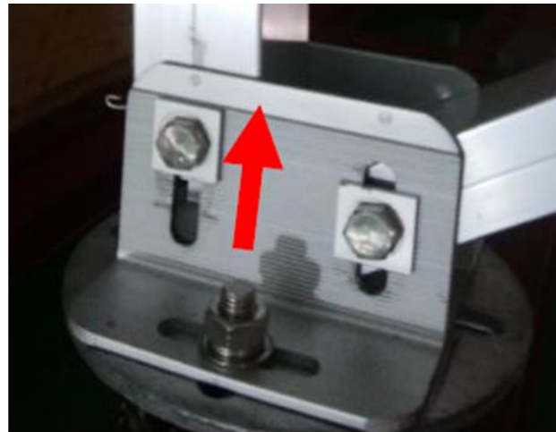
ローレット加工と長孔の接合 のこぎり状の噛み合わせが外れ 長孔方向にズレた事例
