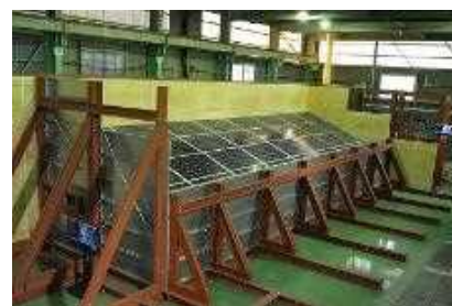
上左: 水平型動風圧試験装置 上右: 加圧ファン 下右: 地上設置型太陽光発電システムの構造設計例(抜粋)
