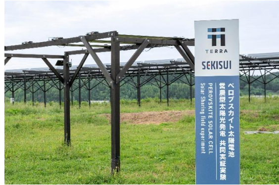
ペロブスカイト太陽電池の実証実験を積水化学工業と共同で実施。ソーラーシェアリング専用開発した局面パネルは、より軽く、より細くなり、農作物にいつそう優しい。奥に見えるのは、一部地域の環境条例に対応するために開発したオールブラック発電設備。
