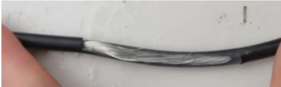
図 6-9 実験①-3 のケーブル破損状況
