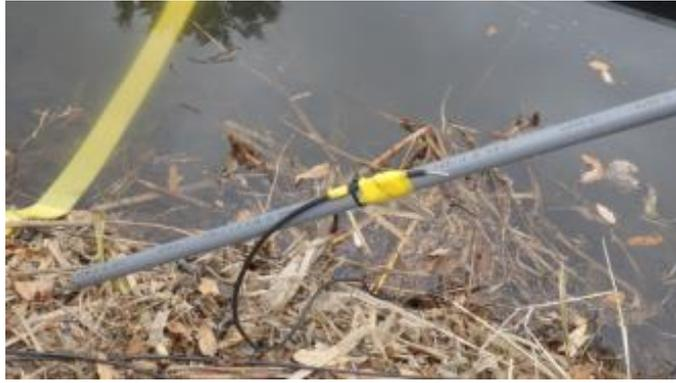
図 7-13 直流ケーブル破損 断線箇所
